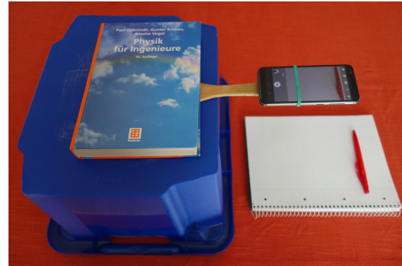
Abbildung 1 Improvisiertes Stativ zum Abfilmen der Handschrift aus Plastikbox, Pflanzentopf, Buch und Haushaltsgummi, siehe auch https://mathiasmagdowski.wordpress.com/2019/04/28/improvisiertes-stativ-zum-abfilmen-einer-schreibenden-hand/
